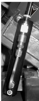
В данной конструкции ленточной пилы LM-128SHD/220 скорость опускания рамы устанавливается при помощи регулирующего винта (A) (смотри фото слева) на гидравлическом цилиндре.
