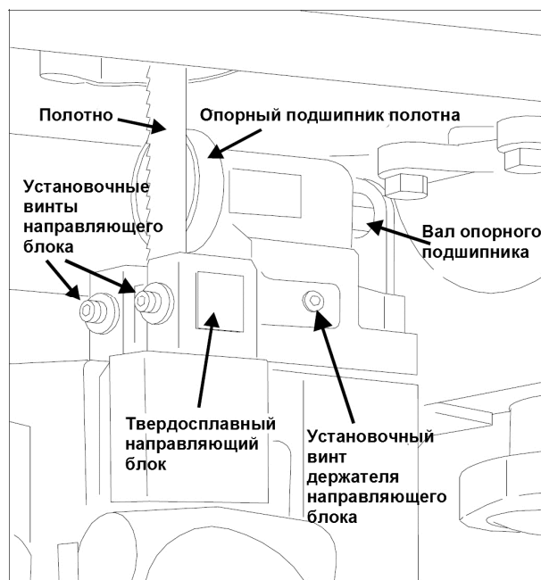
Рисунок 14. Нижний опорный узел полотна.
