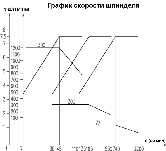
Рисунок 6 График мощности и вращающего момента шпинделя
