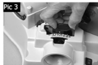
D. Соответствующей ручкой установите величину съема материала от «1» до «4». (рис.4) Минимальное значение соответствует примерно 0,12-0,25 мм. Каждое следующее значение увеличивает съем материала на 0,12 мм. Если сверло сильно изношено, либо сломано, то требуется большой съем материала.
